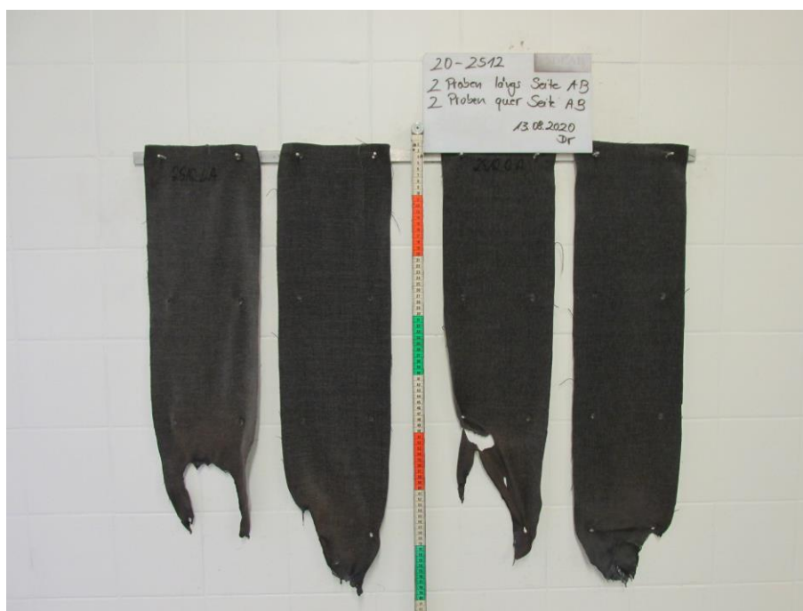
Bild 2: Aussehen der Proben nach dem Brandversuch
