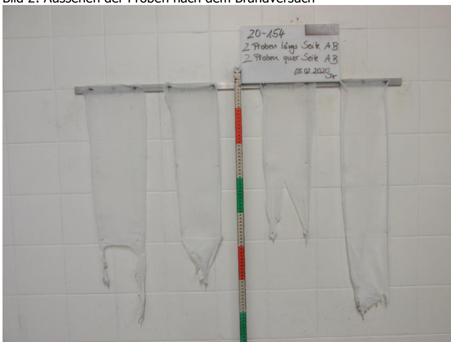
Bild 2: Aussehen der Proben nach dem Brandversuch
