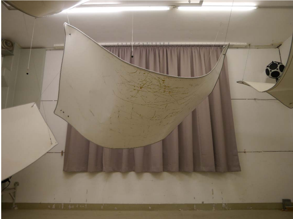
Abbildung B.1. Prüfobjekt im Hallraum: Frontalansicht.
