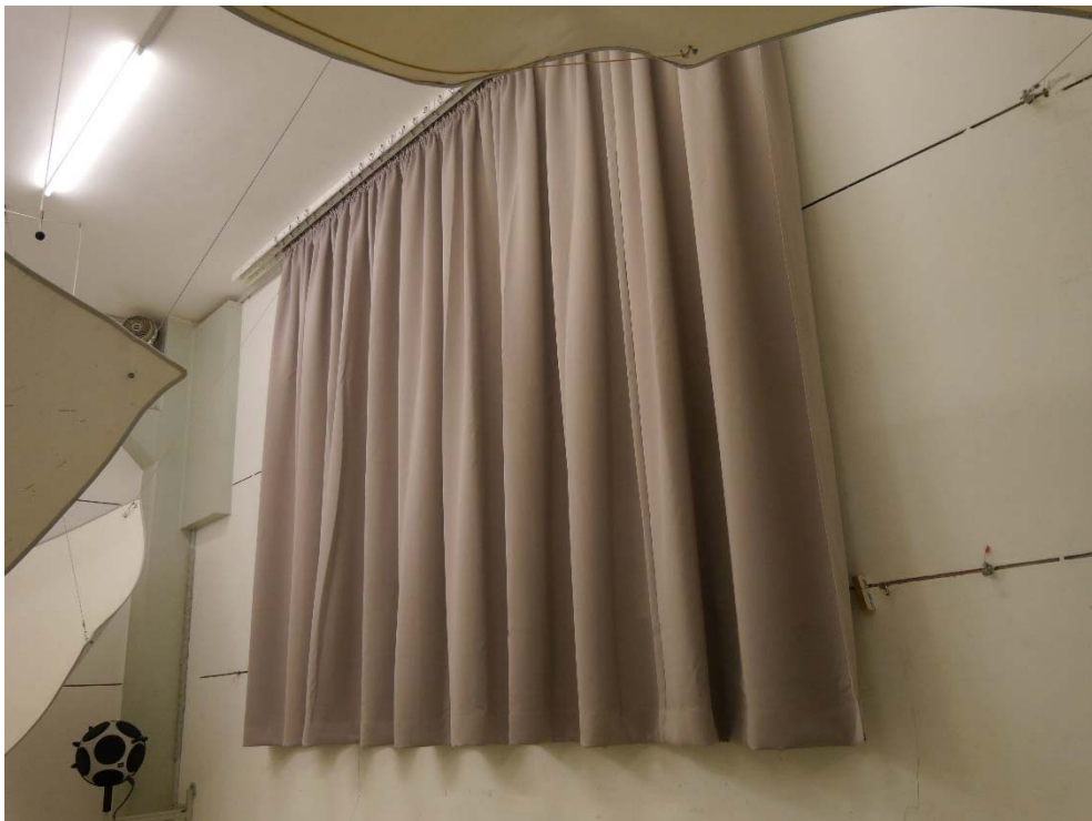
Abbildung B.2. Prüfobjekt im Hallraum: Schrägansicht.
