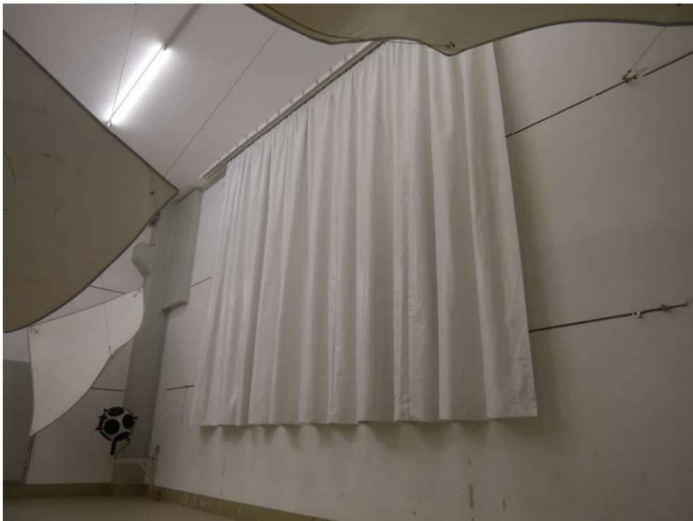
Abbildung B.2. Prüfbjekt im Hallraum: Schrägansicht.
