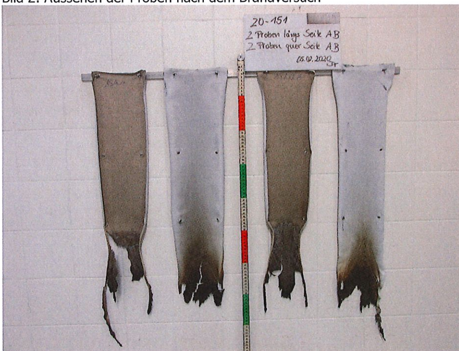
Bild 2: Aussehen der Proben nach dem Brandversuch
