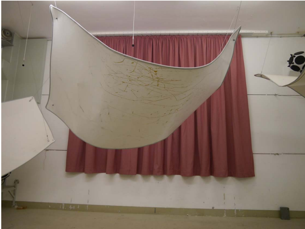
Abbildung B.1. Prüfanordnung im Hallraum (Frontalansicht).
