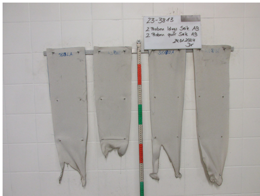
Bild 2: Aussehen der Proben nach dem Brandversuch
