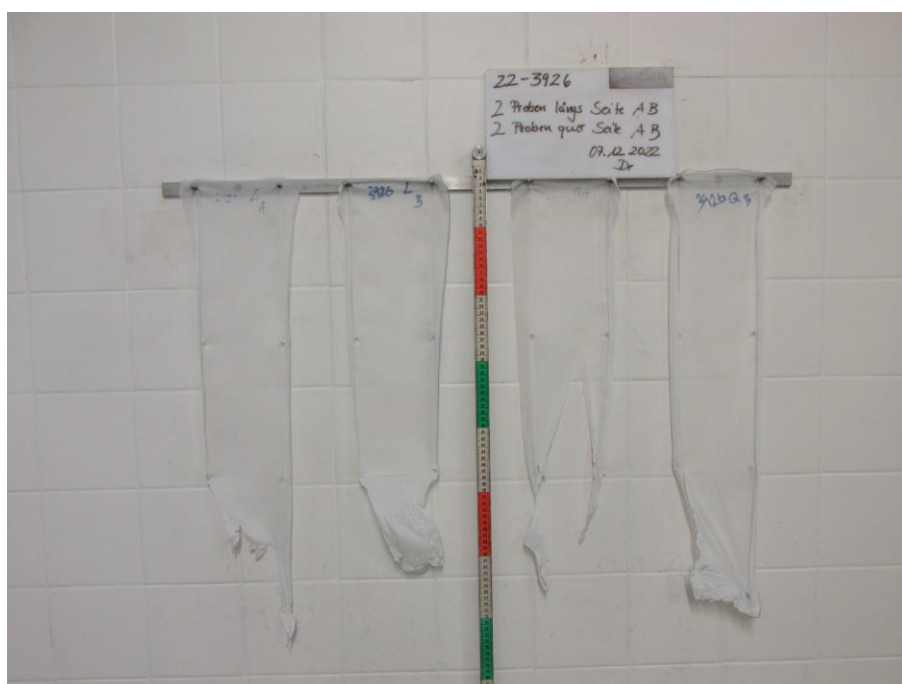
Bild 2: Aussehen der Proben nach dem Brandversuch
