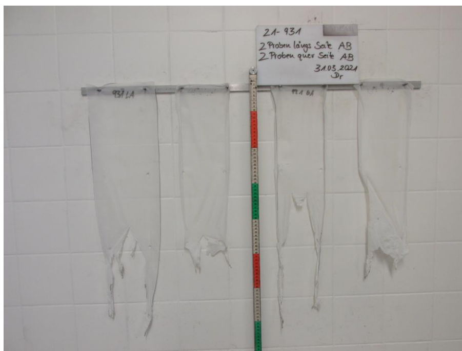
Bild 2: Aussehen der Proben nach dem Brandversuch
