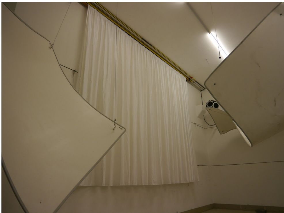
Abbildung B.2. Prüfanordnung im Hallraum (Schrägensicht).
