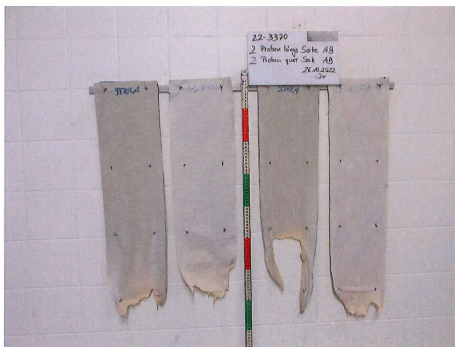
Bild 2: Aussehen der Proben nach dem Brandversuch
