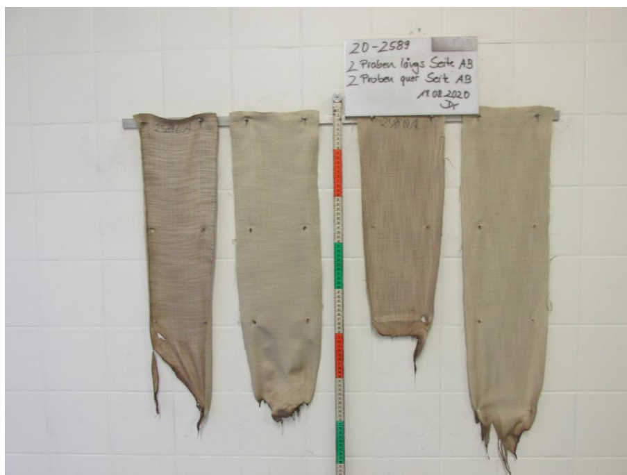
Bild 2: Aussehen der Proben nach dem Brandversuch
