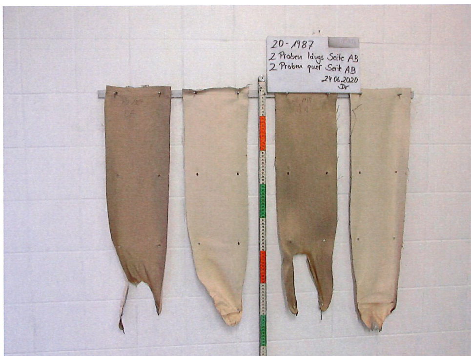
Bild 2: Aussehen der Proben nach dem Brandversuch
