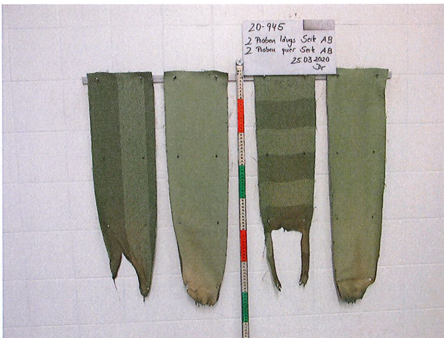
Bild 2: Aussehen der Proben nach dem Brandversuch
