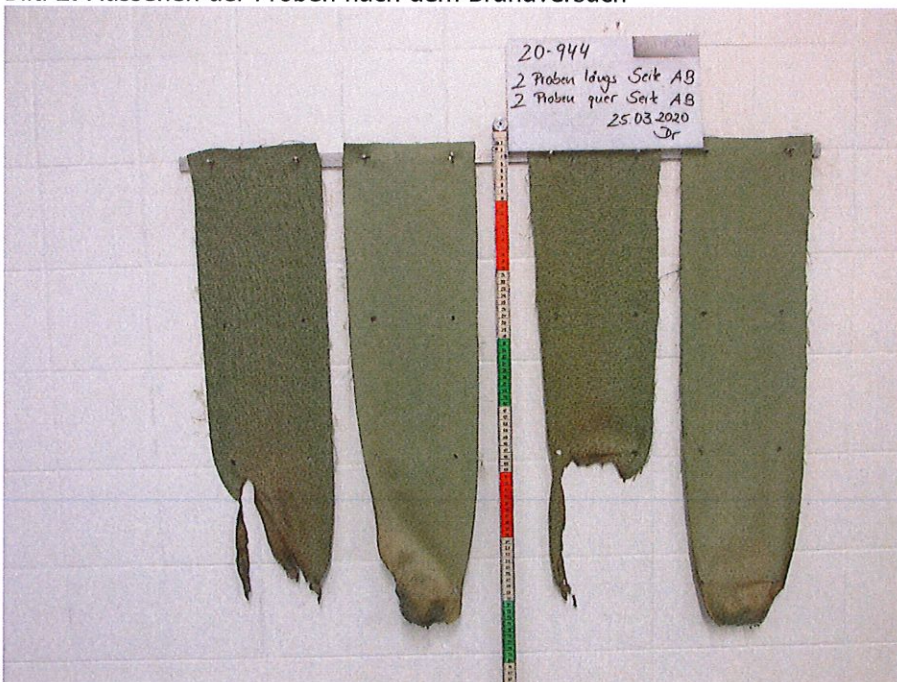
Bild 2: Aussehen der Proben nach dem Brandversuch
