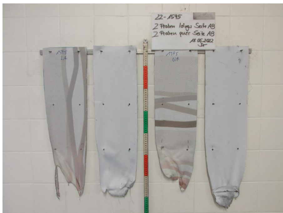
Bild 2: Aussehen der Proben nach dem Brandversuch
