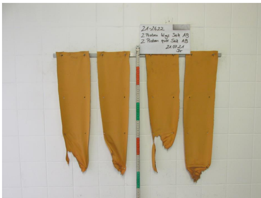
Bild 2: Aussehen der Proben nach dem Brandversuch
