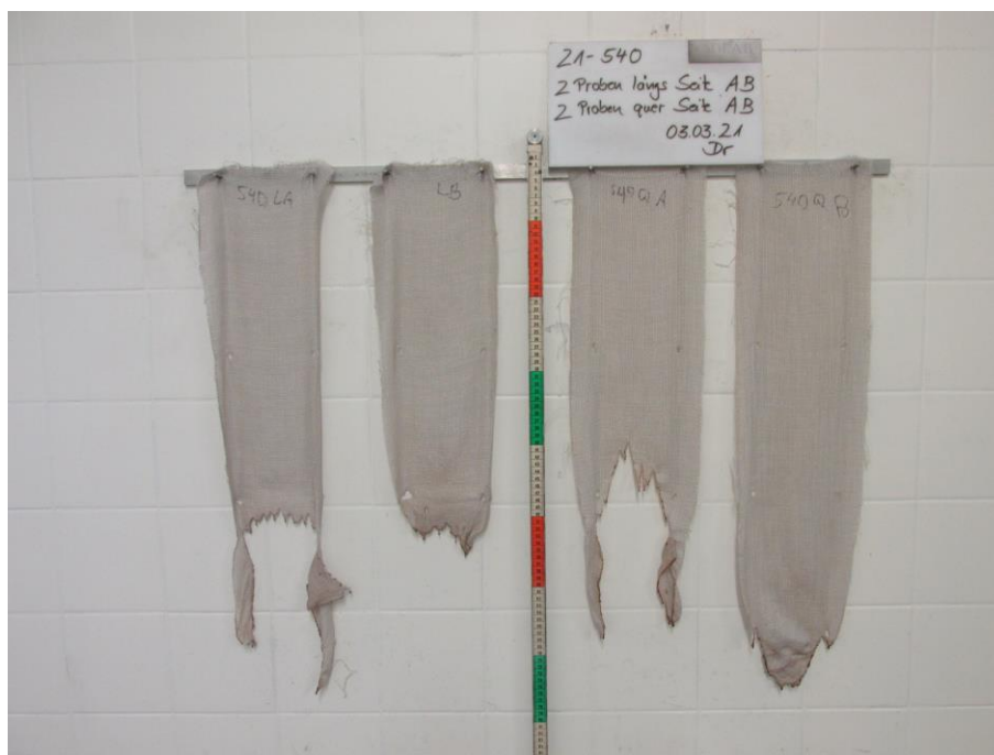
Bild 2: Aussehen der Proben nach dem Brandversuch
