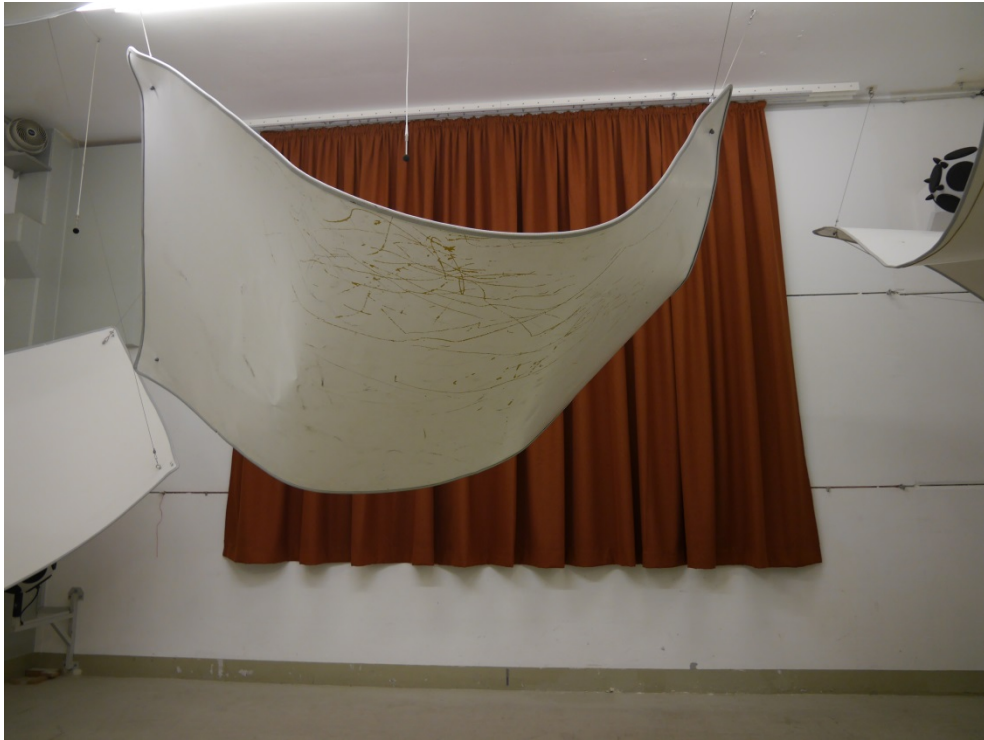
Abbildung B.1. Prüfanordnung im Hallraum (Frontalansicht).
