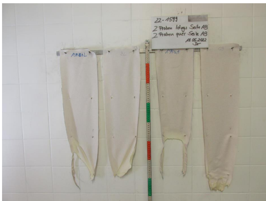
Bild 2: Aussehen der Proben nach dem Brandversuch
