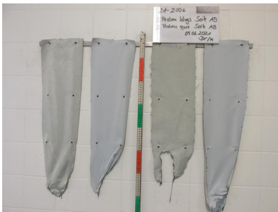
Bild 2: Aussehen der Proben nach dem Brandversuch
