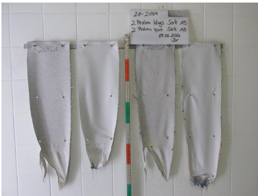
Bild 2: Aussehen der Proben nach dem Brandversuch
