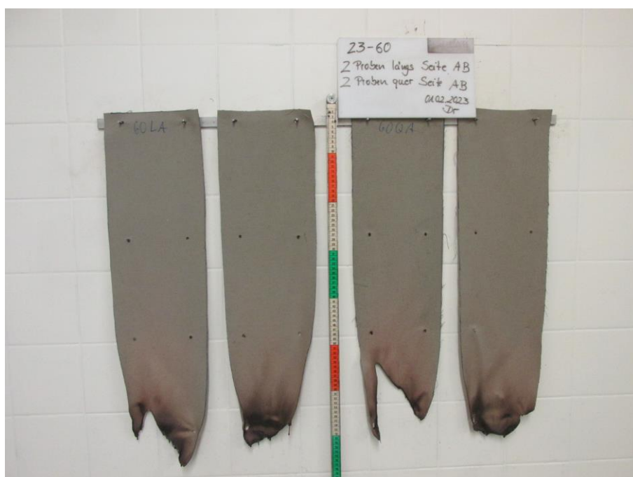
Bild 2: Aussehen der Proben nach dem Brandversuch
