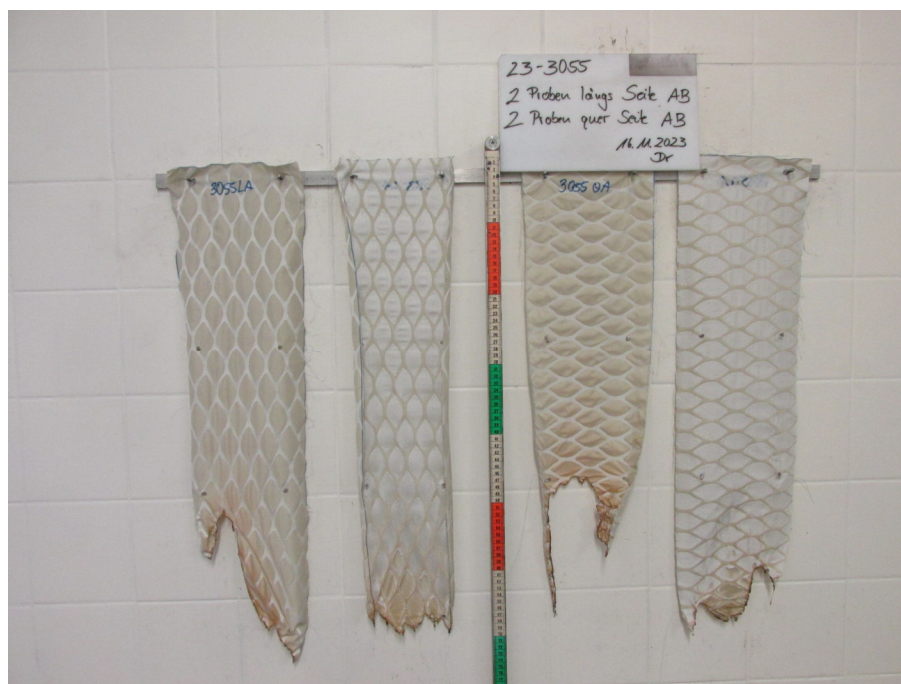
Bild 2: Aussehen der Proben nach dem Brandversuch
