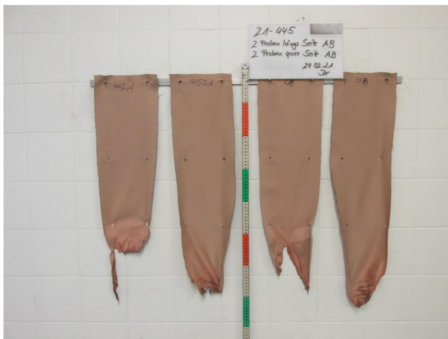
Bild 2: Aussehen der Proben nach dem Brandversuch
