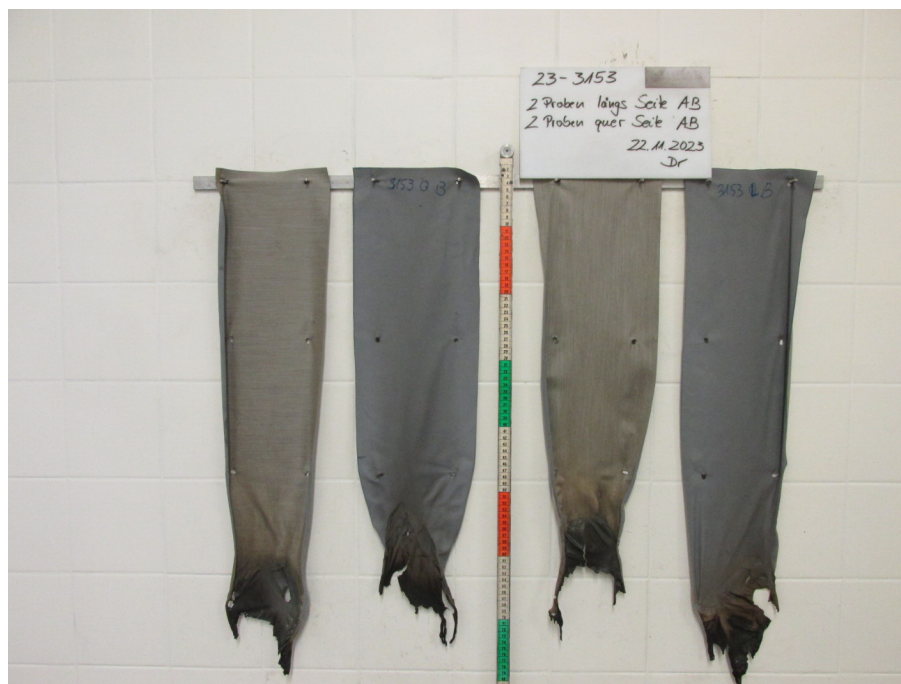
Bild 2: Aussehen der Proben nach dem Brandversuch
